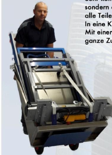
Sehr kompakt nicht nur Aufgebaut, sondern auch im zerlegten Zustand, alle Teile lassen sich bequem In eine Kiste 72 x 100 cm verstauen Mit einer geeigneten Sackkarre wird das ganze Zubehör zum Einsatzort gefahren.
