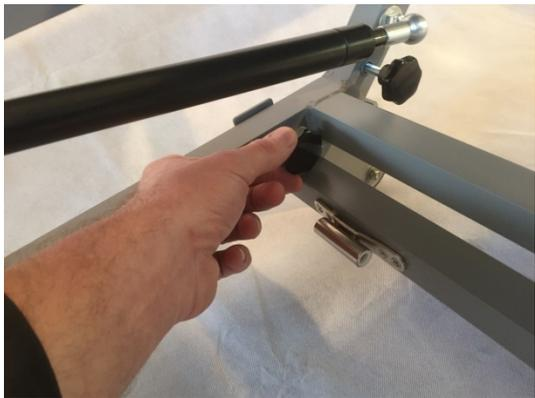
2. Die Arretierbolzen für die Hinterbeine links und rechts lösen.
