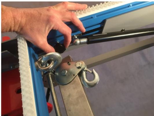
11. Die Seile mit den Seilwinden auf Spannung bringen und die anschließend Arretier Bolzen links und rechts lösen.
