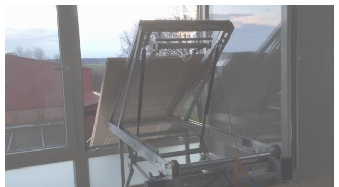
Einsatz über ein Mauerwerk oder Balkongeländer mit Gegengewicht ( Last gleich Ballast )
