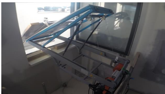
Einsatz über ein Mauerwerk oder Balkongeländer mit Gegengewicht ( Last gleich Ballast )
